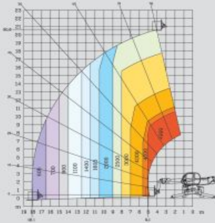
ROTATION SUR STABILISATEURS INTERMEDIAIRES AVEC FOURCHES
